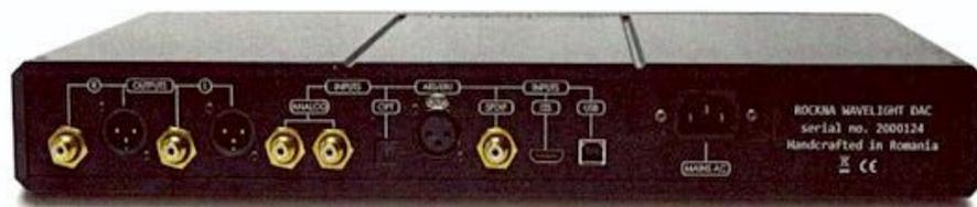
À l'arrière, c'est de qualité et complet : sorties RCA + XLR, entrée analogique RCA et cinq entrées numériques, dont une I2S sur prise HDMI, pour les lecteurs en disposant. En by-pass, les RCA de l'entrée sont directement reliés à celles de sortie par l'intermédiaire d'un relais.
