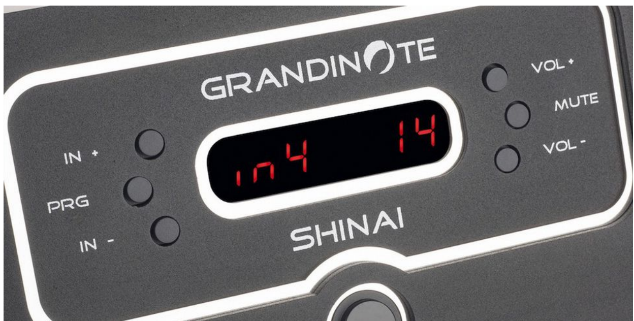
Das Display ist eine klassische Lösung mit Siebensegment-LED-Anzeigen
