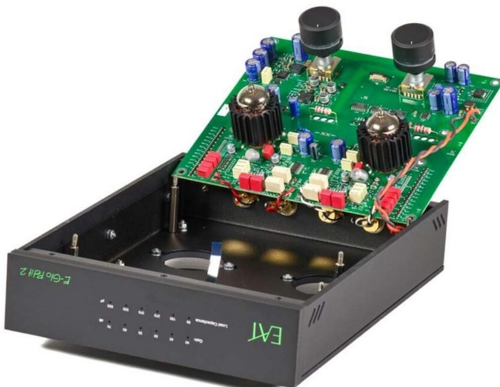
*Das Thema sind Röhren, die Umsetzung ist allerdings hybrid: Die beiden 12AX7 sind in der Eingangsstufe tätig, den Ausgang bearbeiten Transistoren. Um Aufwärmphasen zu umgehen, sind die Kolben permanent beheizt.*
