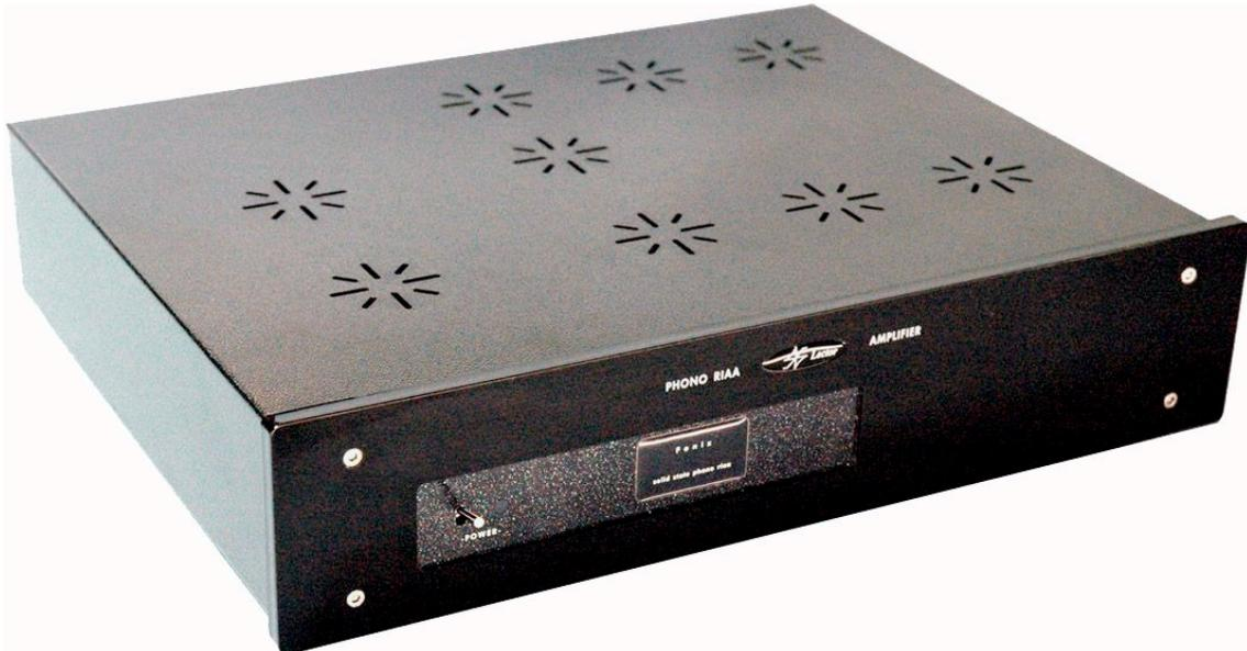
Fonix est un préamplificateur phono à transistors offrant deux entrées sur deux circuits indépendants : une pour aimant mobile et une pour bobine mobile. Deux platines TD peuvent donc être connectées simultanément, l'une équipée d'une cellule MM et l'autre d'une cellule MC. L'impédance de cette dernière peut être ajustée à l'aide d'un jeu de résistances différentes sous la forme de prises RCA.
