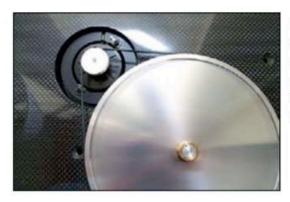
Der Subteller des C-Sharp wiegt etwa ein Kilogramm und besitzt mittig einen dicken Zapfen, der zur Zentrierung des eigentlichen Plattentellers dient. Das Lager selbst ist ein sogenanntes Inverslager, dessen tragende Keramikkugel am oberen Ende der Achse angeordnet ist.
