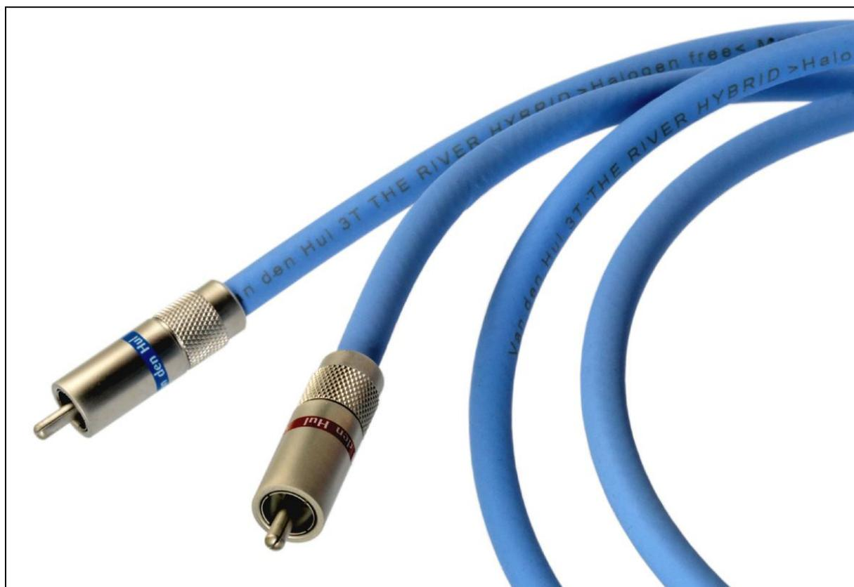
The RIVER Hybrid est notre câble de modulation vous permettant d'aborder la gamme de nos câbles conçus sur notre nouvelle technologie révolutionnaire 3T (True Transmission Technology). Le conducteur central de ce câble coaxial, de nature asymétrique, est constitué de 19 brins 3T de 0,15 mm, entourés par une couches de L.S.C. fibres de carbone, une autre de nos technologies brevetées.
