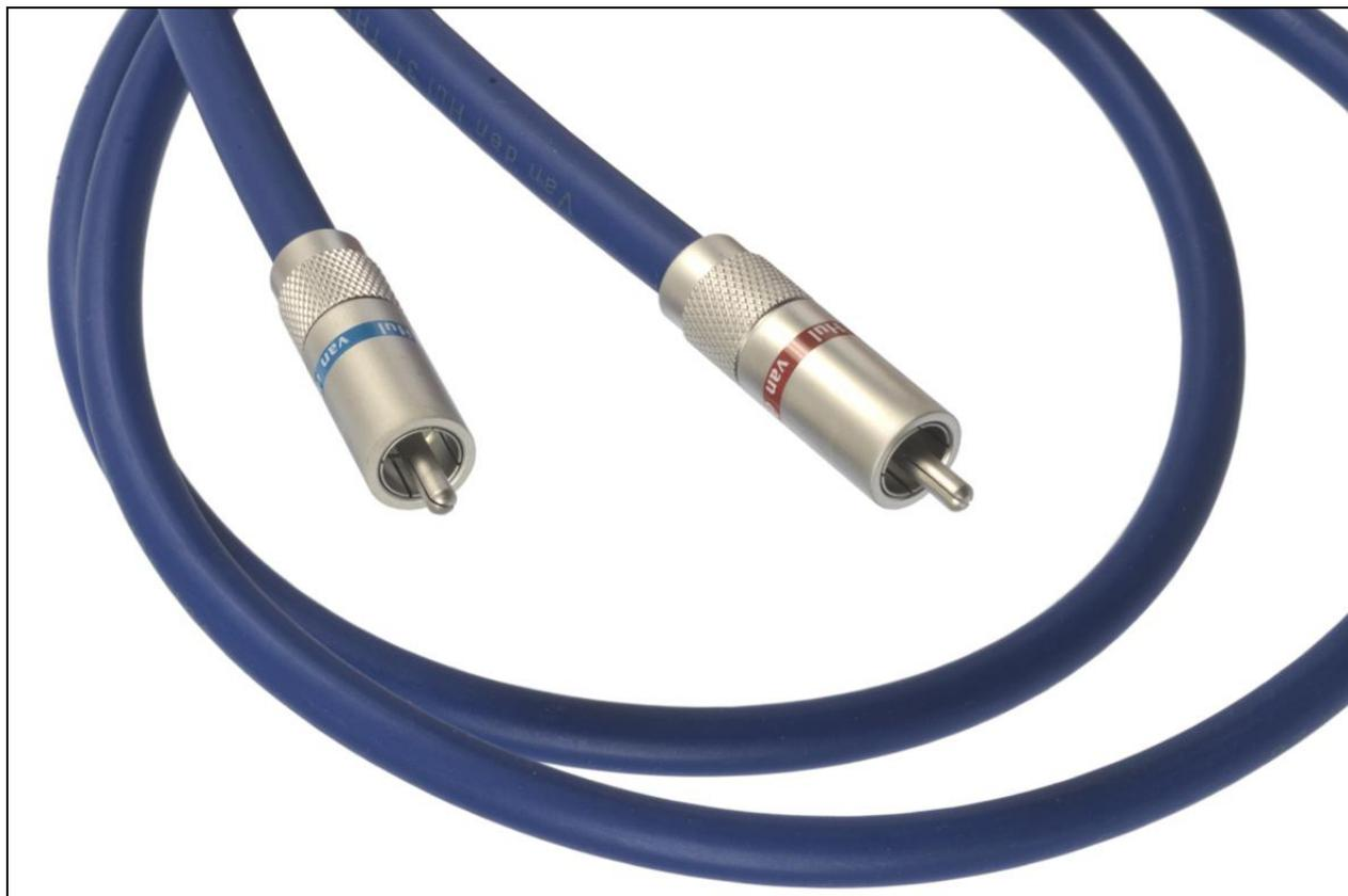
The SEA Hybrid est un câble de modulation coaxial, de nature asymétrique, conçu à partir de conducteur de la technologie 3T. Le conducteur central est un brin de 0,4 mm de diamètre entouré d'une couche de fibres en carbone isolées L.S.C. Le blindage est une tresse dense constituée de cuivre plaqué argent combiné à des conducteurs 3T. L'ensemble est protégé par une gaine Hulliflex bleue.
